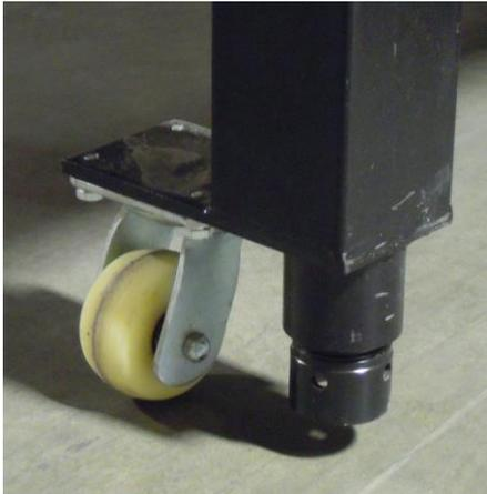
Le pont four SE est équipé de quatre (4) pieds réglables situés sous le socle de l'équipement, deux à l'avant et deux à l'arrière.
