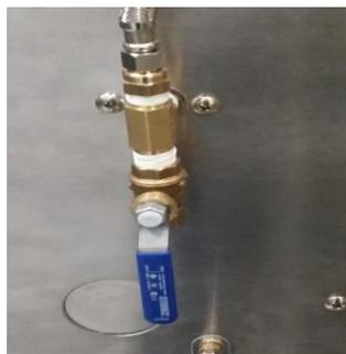
Le top four à sole est fournie par l'usine avec un 1/2 "vanne à boisseau sphérique TNP et" Y "passoire. La connexion d'alimentation en eau se fait à la 1/2" robinet à boisseau sphérique. La connexion d'alimentation doit être faite avec une ligne flexible adapté pour permettre le four pour être déplacé dans et hors de position.
